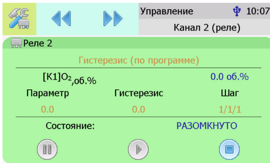
Рисунок 6.33 Экран канала управления с настроенной программой.
